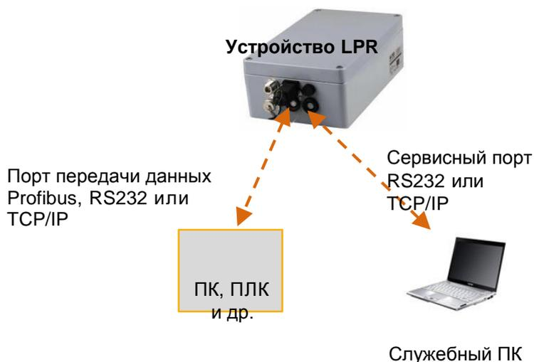
Рисунок 29: Устройство LPR<sup>®</sup> с интерфейсами для параметризации через сервисный порт и протокол передачи данных о расстоянии (двоичная информация) через порт передачи данных
